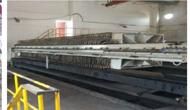
Pemrosesan dan Daur Ulang Limbah Cair Produksi dengan Teknik Pemfiltrasi
